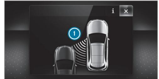
Si se produce una intervención en el freno para corregir la dirección, parpadea el testigo luminoso de advertencia rojo del retrovisor exterior y suena una señal acústica de advertencia. Adicionalmente se muestra una indicación
