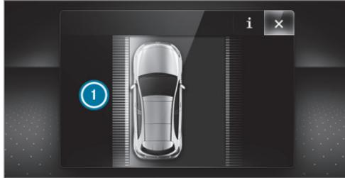
Si se produce una intervención en el freno para corregir el carril, en el visualizador del cuadro de instrumentos se muestra la indicación ⓘ.
