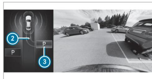
En el visualizador de medios se muestran los huecos para aparcar detectados por el sistema. Cuando el vehículo está parado, se muestra además el recorrido definido ② para acceder al hueco para aparcar seleccionado en ese momento ③.
