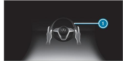
Si el sistema detecta que el conductor no gira el volante o que retira las manos del volante durante cierto tiempo, se emite la indicación ①. Si el conductor sigue sin mover el volante de forma activa, además de la advertencia óptica suena una señal acústica de advertencia.
