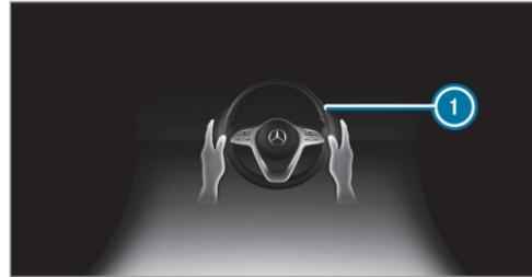
Si el sistema detecta que el conductor no gira el volante o que retira las manos del volante durante cierto tiempo, se muestra la indicación ① en el visualizador del cuadro de instrumentos. Si el conductor sigue sin realizar maniobras de forma
