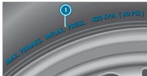
**i** Los datos de la ilustración son ejemplos. Nunca se debe sobrepasar la presión máxima admisible del neumático **1** para la que el neumático está homologado. Al ajustar la presión del neumático, tenga siempre en cuenta la presión recomendada para el vehículo. (→ página 359)
