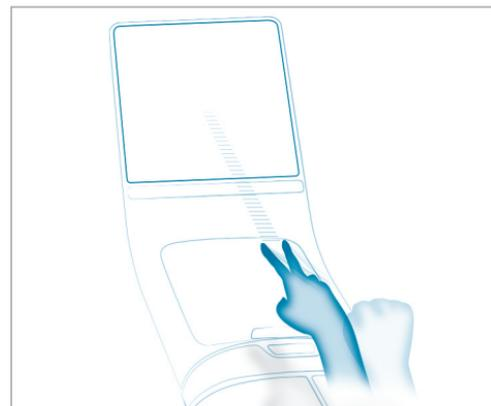
Ejecución del gesto de la V sobre el compartimento portaobjetos de la consola central a la altura del visualizador central
