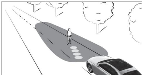
La función spotlight funciona en segundo plano e ilumina a las personas detectadas dentro de la línea delimitadora del carril con cuatro breves impulsos con los faros. El conductor recibe información sobre la posición de los peatones que se aproximen en sentido contrario mediante una proyección de símbolos.
