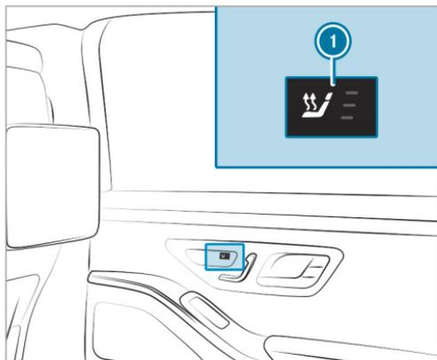
▶ Pulse repetidamente la tecla ① hasta alcanzar el nivel de calefacción deseado. En función del nivel de calefacción, se iluminan de uno a tres testigos de control. Si todos los testigos de control están apagados, la calefacción de asiento está desconectada.
