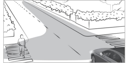
La luz de giro mejora la iluminación de la calzada en la dirección de giro de manera que, por ejemplo, las curvas cerradas sean más visibles. Solo puede activar el sistema si la luz de cruce está conectada.
