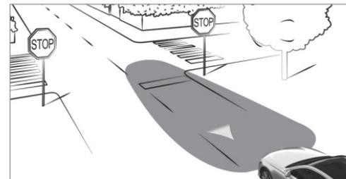
Si el asistente para señales de tráfico detecta la situación correspondiente y se está circulando a una velocidad de 30 km/h como mínimo, se proyecta un triángulo en la calzada en los siguientes casos:
