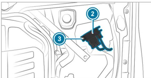
▶ En función del equipamiento del vehículo, en la tapa de la caja de fusibles existe un componente eléctrico ②. Si está disponible, suelte el tornillo ③ y aparte el componente a un lado sin desconectar las conexiones eléctricas.
