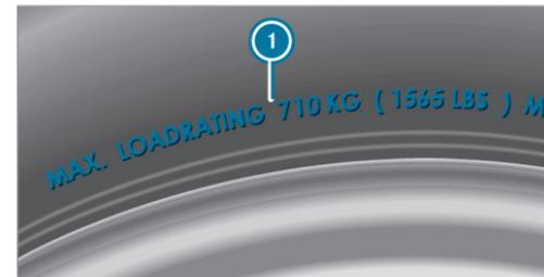
**i** Los datos de la ilustración son ejemplos. La carga máxima del neumático **1** es el peso máximo admisible para el que está homologado el neumático.
