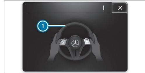
Si el sistema detecta que el conductor no realiza maniobras durante cierto tiempo o retira las manos del volante, en primer lugar se emite una advertencia óptica. En el visualizador del conductor se muestra la indicación ①. Si el conductor sigue sin realizar maniobras de forma activa o no responde al sistema, adicionalmente a la advertencia óptica se emite repetidamente una señal acústica de advertencia.
