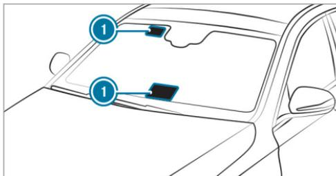
Los aparatos accionados por radio como, por ejemplo, los sistemas de peaje, solo pueden montarse en las superficies permeables a las ondas de radio ❶ del parabrisas.
