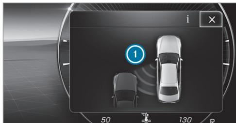
Si se produce una intervención en el freno para corregir la dirección, parpadea el testigo luminoso de advertencia rojo del retrovisor exterior y suena una señal acústica de advertencia. Adicionalmente se muestra una indicación ❶ en el visualizador del conductor que indica el peligro de colisión lateral.
