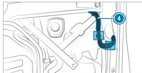
▶ Si están disponibles, suelte los tubos flexibles ④ de las pinzas de sujeción de la caja de fusibles y de la carrocería.
