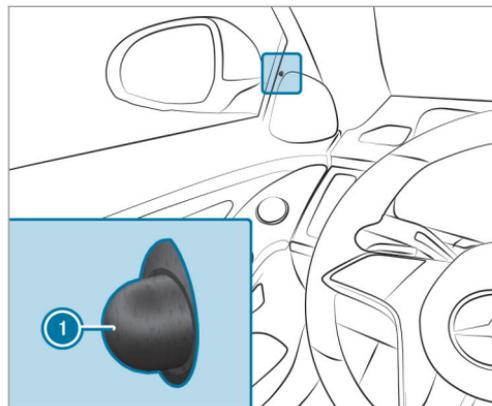
Al bloquear el vehículo desde el exterior, el testigo de control ① situado en el revestimiento del lado del conductor parpadea. El testigo de control ① permanece apagado si bloquea el vehículo desde el habitáculo o durante la marcha.
