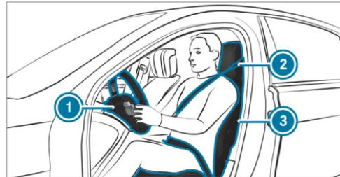
Al ajustar el volante ①, el cinturón de seguridad ② y el asiento del conductor ③, tenga en cuenta lo siguiente:
