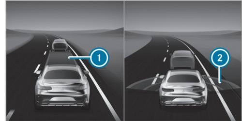
En el menú **Asistencia**, una distancia insuficiente **1** respecto al vehículo precedente se muestra en rojo. Si la distancia sigue disminuyendo, también se destaca en color rojo el vehículo precedente. En caso de que se detecte un peligro de colisión, se muestran ondas de radar rojas **2** delante del vehículo.
