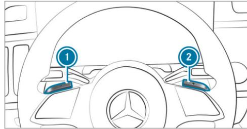
Si el cambio automático está acoplado en la posición **D**, puede cambiar de forma manual con las levas de cambio en el volante. Siempre y cuando esté permitido, el cambio automático acopla una marcha superior o inferior, según la leva de cambio en el volante accionada.
