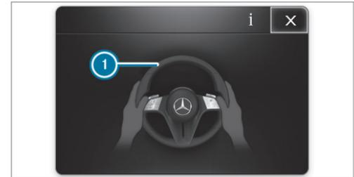
Si el sistema detecta que el conductor no realiza maniobras durante cierto tiempo o retira las manos del volante, se emite una advertencia óptica ①. Si el conductor sigue sin realizar maniobras de forma activa o no responde al sistema, adicionalmente a la advertencia óptica se emite repetidamente una señal acústica de advertencia.
