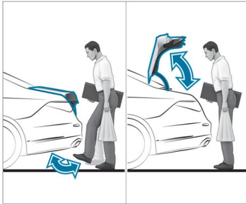
Con HANDS-FREE ACCESS puede abrir, cerrar o detener la tapa del maletero con un movimiento de la pierna en la zona situada debajo del para-choques.
