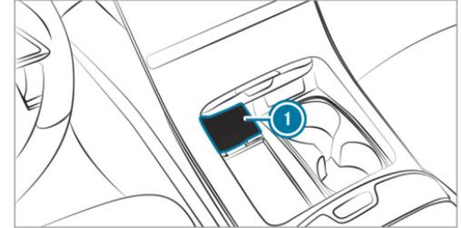
Carga inalámbrica del teléfono móvil en el compartimento portaobjetos delantero (ejemplo)
