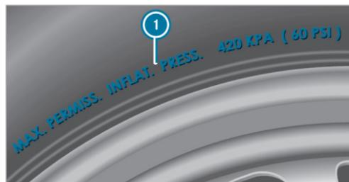
**i** Los datos de la ilustración son ejemplos. Nunca se debe sobrepasar la presión máxima admisible del neumático **1** para la que el neumático está homologado. Al ajustar la presión del neumático, tenga siempre en cuenta la presión recomendada para el vehículo. (→ página 393)
