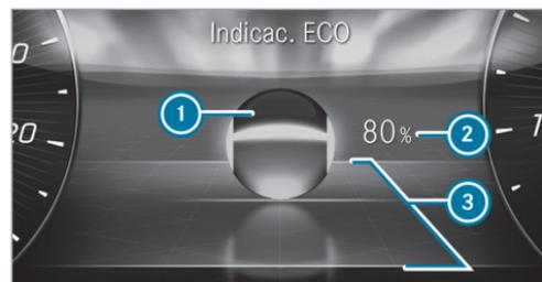
En función de la situación, la indicación ECO muestra en el visualizador del conductor una valoración de su estilo de conducción. Así, puede revisar la eficiencia de su forma de con-
