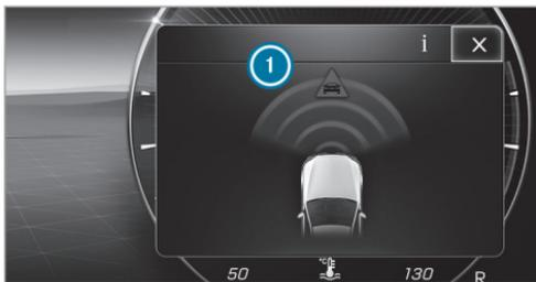
Si se ha realizado un frenado autónomo o se ha activado la amplificación de la fuerza de frenado en función de la situación, en el visualizador del conductor se muestra el mensaje emergente **i** que desaparece automáticamente poco después.
