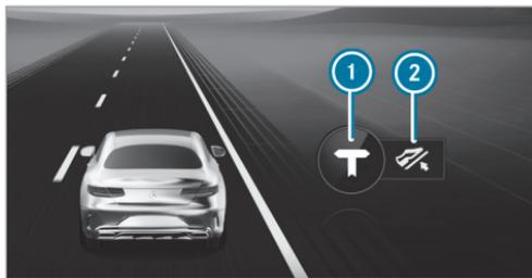
Indicación del asistente ECO en el visualizador del conductor, en el menú **Asistencia**
