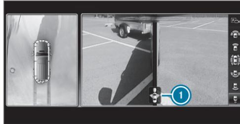
Si establece la conexión eléctrica del vehículo con el remolque, la indicación cambia a una vista de la cámara lateral ①.
