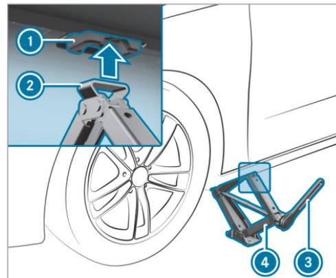
► Coloque la base (2) del gato (4) en el punto de apoyo del gato (1).
