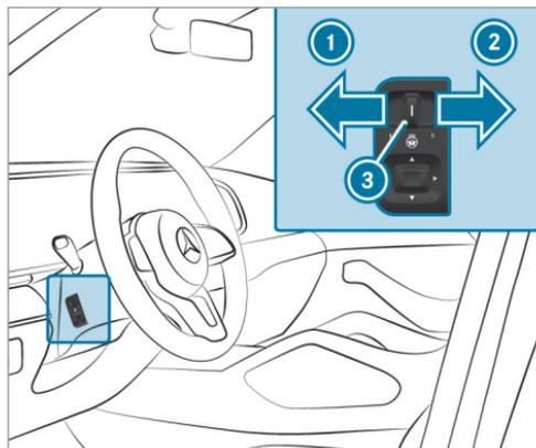
▶ **Conexión:** pulse el interruptor y ajústelo en la posición ①.
