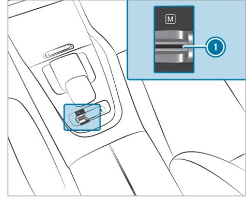
► **Activación/desactivación:** tire del interruptor basculante **1**.
