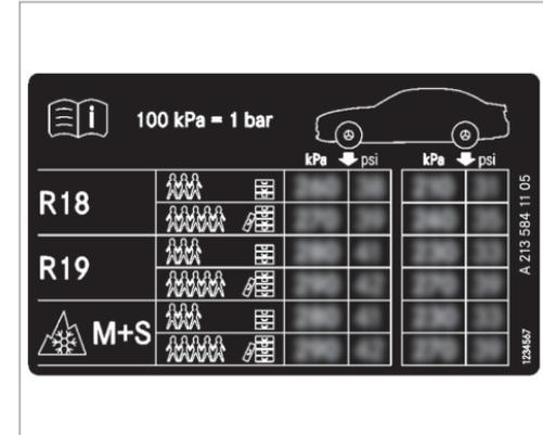
Algunas tablas de presión de neumáticos muestran solo diámetros de llanta en lugar del tamaño de neumático completo, porejemplo, **R18**. El diámetro de la llanta forma parte del tamaño del neumático y está inscrito en el flanco del neumático (→ página 417).
