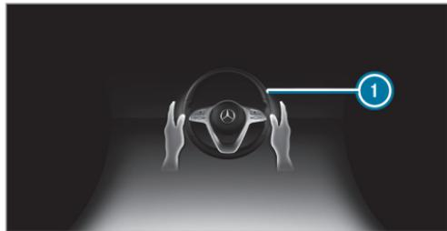
Si el sistema detecta que el conductor no gira el volante o que retira las manos del volante durante cierto tiempo, se muestra la indicación ① en el visualizador del cuadro de instrumentos. Si el conductor sigue sin realizar maniobras de forma activa o no responde al sistema, adicionalmente a la advertencia óptica se emite repetidamente una señal acústica de advertencia.
