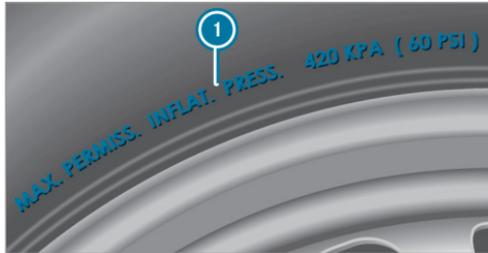
**i** Los datos de la ilustración son ejemplos. Nunca se debe sobrepasar la presión máxima admisible del neumático **1** para la que el neumático está homologado. Al ajustar la presión del neumático, tenga siempre en cuenta la presión recomendada para el vehículo. (→ página 405)
