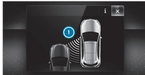
Si se produce una intervención en el freno para corregir la dirección, parpadea el testigo luminoso de advertencia rojo del retrovisor exterior y suena una señal acústica de advertencia. Adicionalmente se muestra una indicación
