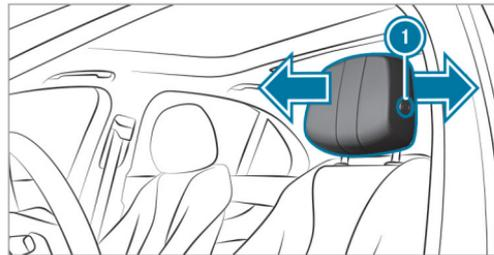
▶ **Ajuste hacia delante:** presione el botón de desbloqueo ① y tire del reposacabezas hacia delante.
