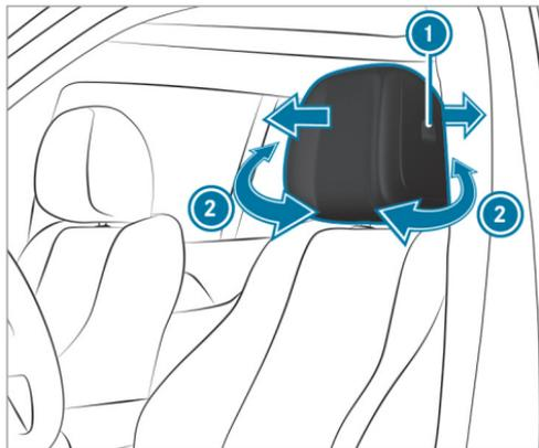
▶ **Ajuste hacia delante:** presione el botón de desbloqueo ① y tire del reposacabezas hacia delante.
