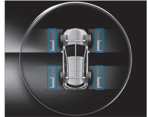
Puede visualizar la distribución actual de los pares de propulsión en las cuatro ruedas en el Head-up-Display y en el sector de visualización derecho del panel de instrumentos. Cuanto más se llene la respectiva escala, mayor será el par de propulsión correspondiente.
