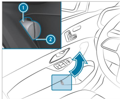
▶ **Extracción:** extraiga la bolsa del chaleco reflectante **1** tirando del lazo **2**.
