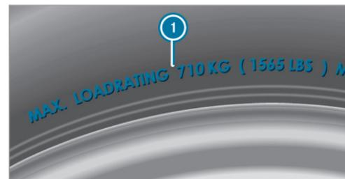
**i** Los datos de la ilustración son ejemplos. La carga máxima del neumático **1** es el peso máximo admisible para el que está homologado el neumático.
