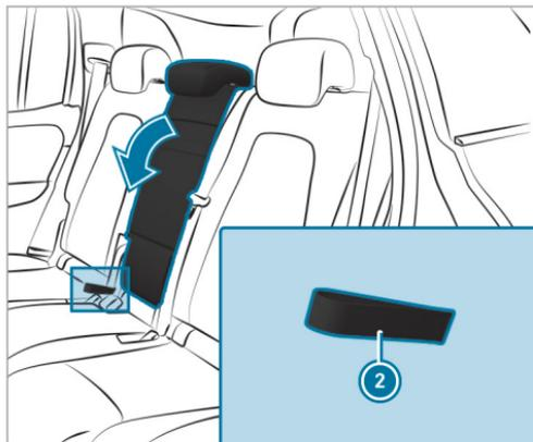
▶ **Respaldo del asiento central:** tire del lazo de desenclavamiento ②. El respaldo del asiento se pliega automáticamente hacia adelante.
