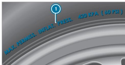
**i** Los datos de la ilustración son ejemplos. Nunca se debe sobrepasar la presión máxima admisible del neumático **1** para la que el neumático está homologado. Al ajustar la presión del neumático, tenga siempre en cuenta la presión recomendada para el vehículo. (→ página 336)
