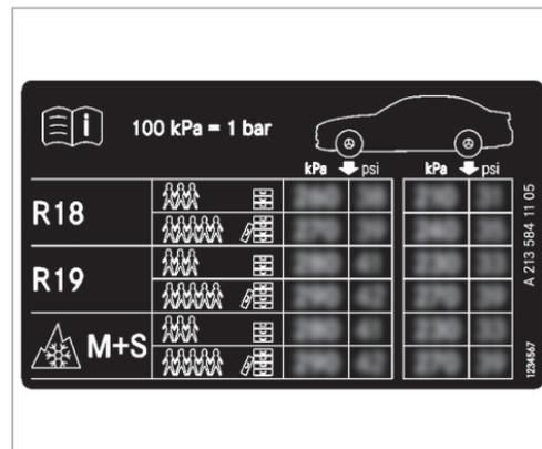
Algunas tablas de presiones de neumáticos muestran solo diámetros de llanta en lugar del tamaño de neumático completo, porejemplo, **R18**. El diámetro de la llanta forma parte del tamaño del neumático y está inscrito en el flanco del neumático (→ página 349).
