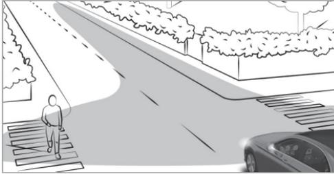
La luz de giro mejora la iluminación de la calzada en la dirección de giro de manera que, por ejemplo, las curvas cerradas sean más visibles. Solo puede activar el sistema si la luz de cruce está conectada.
