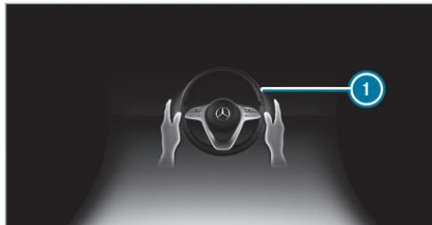
Si sistema detecta que el conductor no gira el volante o que retira las manos del volante durante cierto tiempo, se emite la indicación
