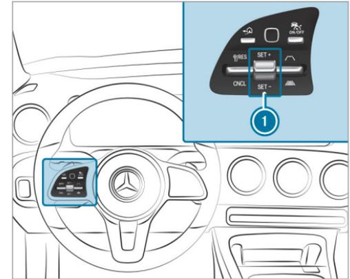
▶ **Aumento/reducción del objetivo de velocidad:** pulse el interruptor basculante **1** hacia arriba **SET+** o hacia abajo **SET-** hasta el punto de resistencia. El objetivo de velocidad aumenta o disminuye en pasos de 1 mph (1 km/h) y se muestra en el visualizador multifunción junto a la indicación de estado
