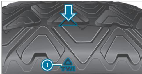
Seis marcas ① muestran en qué puntos están integradas las marcas en forma de barra (flecha) en el perfil del neumático. Son visibles en cuanto se alcanza una profundidad de perfil de neumático de aprox.  $\frac{1}{16}$  in (1,6 mm).
