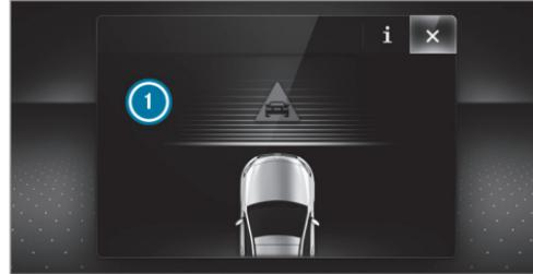
Si se ha realizado un frenado autónomo o se ha activado la servoasistencia de frenado en función de la situación, en el visualizador multifunción se muestra la indicación
