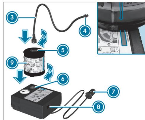
▶ Tire del enchufe ⑦ con el cable y el tubo flexible de llenado ③ de la carcasa del compresor de inflado de neumáticos.
