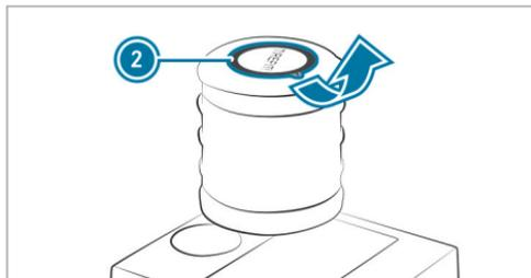
▶ Retire el adhesivo ② de la botella del producto sellador de neumáticos y péguelo cerca de la válvula de la rueda del neumático averiado.
