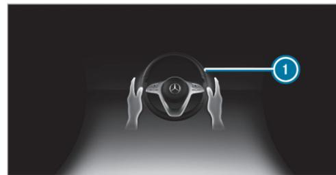
Si el sistema detecta que el conductor no gira el volante o que retira las manos del volante durante cierto tiempo, se emite la indicación ❶. Si el conductor sigue sin mover el volante de forma activa, además de la advertencia óptica suena una señal acústica de advertencia.
