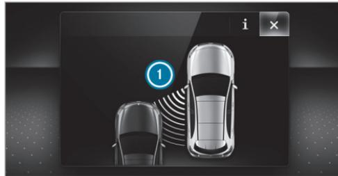
Si se produce una intervención en el freno para corregir la dirección, parpadea el testigo luminoso de advertencia rojo del retrovisor exterior y suena una señal acústica de advertencia. Adicionalmente se muestra una indicación ① en el visualizador multifunción que indica el peligro de colisión lateral.
