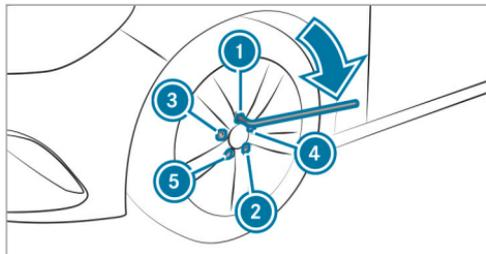
▶ Apriete los tornillos de rueda uniformemente en cruz en el orden indicado del ① al ⑤ en principio con un máximo de 59 lb-ft (80 Nm).
