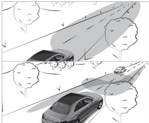
Las luces de carretera automáticas cambian automáticamente entre los siguientes tipos de luces:
