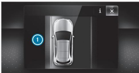
Si se produce una intervención en el freno para corregir el carril, en el visualizador multifunción se muestra la indicación **i**.
