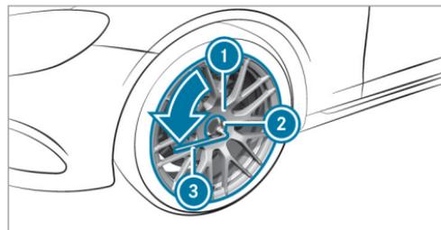
▶ **Desmontaje:** coloque la llave de vaso ② de las herramientas para cambio de rueda sobre el tapacubos ①.
