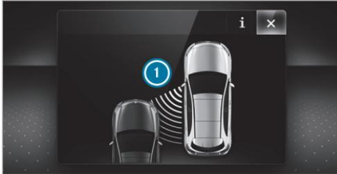
Si se produce una intervención en el freno para corregir la dirección, parpadea el testigo luminoso de advertencia rojo del retrovisor exterior y suena una señal acústica de advertencia. Adicionalmente se muestra una indicación ⓘ en el visualizador multifunción que indica el peligro de colisión lateral.
