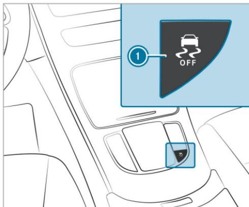
▶ **Desconexión del sistema ESP®:** pulse la tecla ① hasta que se ilumine el testigo luminoso de advertencia ESP® OFF del cuadro de instrumentos. En el visualizador multifunción se muestra el aviso .
