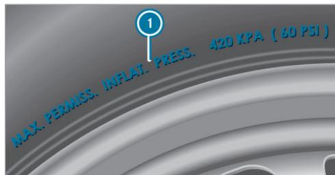
**i** Los datos de la ilustración son ejemplos. Nunca se debe sobrepasar la presión máxima admisible del neumático **1** para la que el neumático está homologado. Al ajustar la presión del neumático, tenga siempre en cuenta la presión recomendada para el vehículo. (→ página 351)
