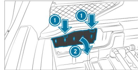
Para soltar las grapas de fijación ① de la cubierta, presione hacia abajo y levante la cubierta en la dirección de la flecha ②.
