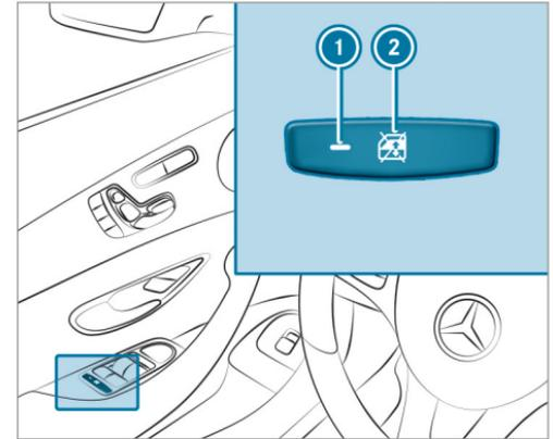
▶ **Activación/desactivación del seguro:** pulse la tecla ②.
