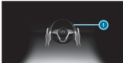
Si el sistema detecta que el conductor no gira el volante o que retira las manos del volante durante cierto tiempo, se emite la indicación ① en el visualizador multifunción. Si el conductor sigue sin realizar maniobras de forma activa o no responde al sistema, adicionalmente a la adver-
