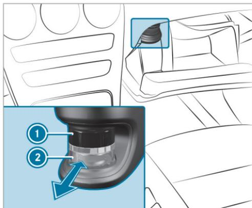
▶ **Colocación:** inserte el frasco ② en el soporte hasta el tope.
