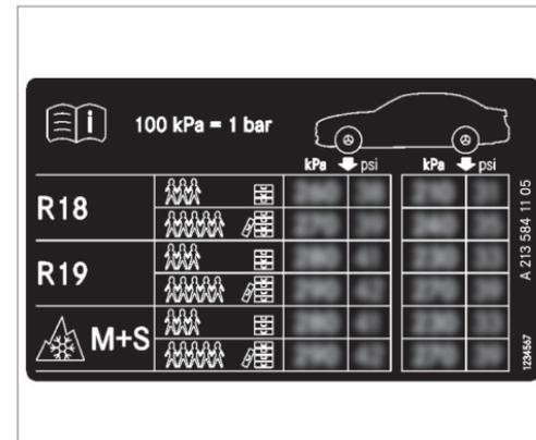
Algunas tablas de presiones de neumáticos muestran solo diámetros de llanta en lugar del tamaño de neumático completo, porejemplo, **R18**. El diámetro de la llanta forma parte del tamaño del neumático y está inscrito en el flanco del neumático (→ página 365).
