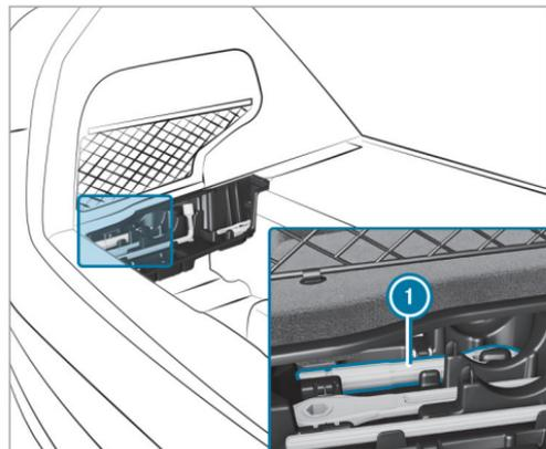
La argolla para remolcado ❶ se encuentra debajo del piso del compartimento de carga.
