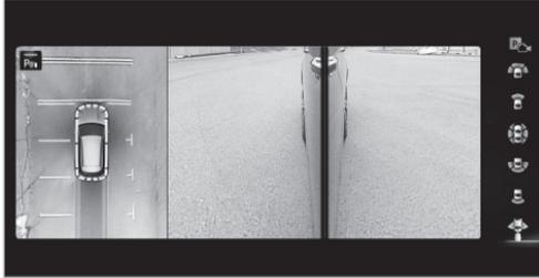
Si establece la conexión eléctrica del vehículo con el remolque, la indicación cambia a una vista de la cámara lateral.
