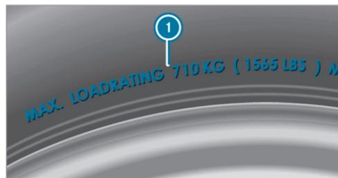
**i** Los datos de la ilustración son ejemplos. La carga máxima del neumático ① es el peso máximo admisible para el que está homologado el neumático.
