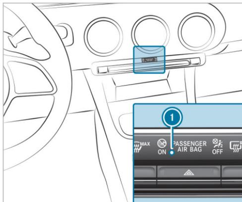
Si el sistema EDW está conectado, el testigo de control ❶ parpadea.
