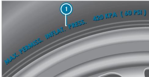
**i** Los datos de la ilustración son ejemplos. Nunca se debe sobrepasar la presión máxima admisible del neumático **1** para la que el neumático está homologado. Al ajustar la presión del neumático, tenga siempre en cuenta la presión recomendada para el vehículo. (→ página 332)
