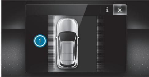
Si se produce una intervención en el freno para corregir el carril, en el visualizador del cuadro de instrumentos se muestra la indicación ❶.
