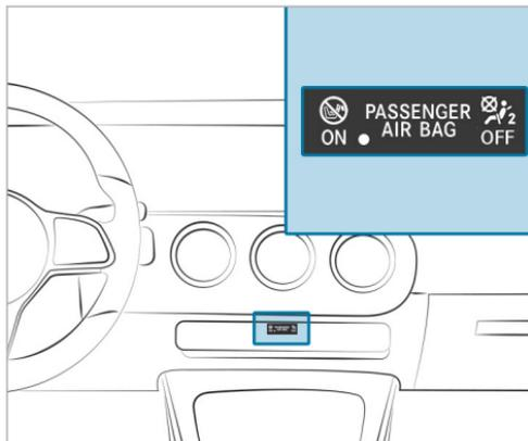
Los testigos de control PASSENGER AIR BAG muestran el estado del airbag del acompañante.
