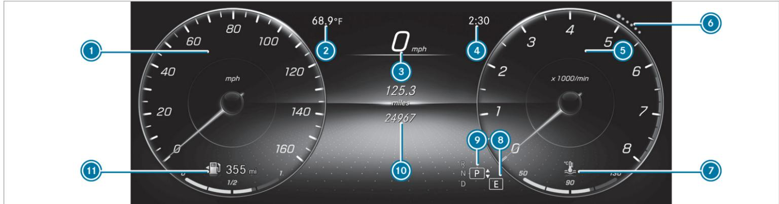
1 Sector de visualización izquierdo del cuadro de instrumentos (ejemplo, velocímetro): velocímetro/hora/fecha/ordenador de viaje Desde inicio y Desde reset/autonomía/audio Los segmentos del velocímetro muestran el estado de los siguientes sistemas: TEMPO-MAT/limitador de velocidad/asistente activo de distancia DISTRONIC.
