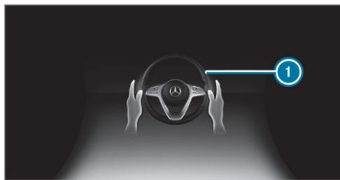
Si el sistema detecta que el conductor no gira el volante o que retira las manos del volante durante cierto tiempo, se emite la indicación ①. Si el conductor sigue sin realizar maniobras de forma activa o no responde al sistema, adicionalmente a
