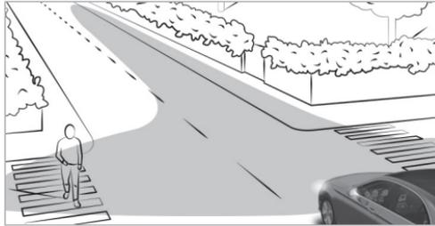
La luz de giro mejora la iluminación de la calzada en la dirección de giro, de manera que, por ejemplo, las curvas cerradas sean más visibles. Solo se activa la luz de giro si la luz de cruce está conectada.
