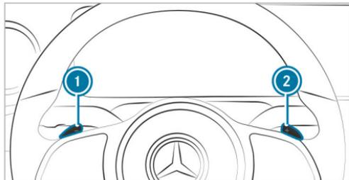
Si el cambio automático está acoplado en la posición **D**, puede cambiar de forma manual con las levas de cambio en el volante. Siempre y cuando
