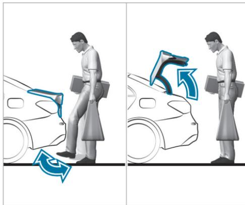
Con HANDS-FREE ACCESS puede abrir la tapa del maletero con un movimiento de la pierna en la zona situada debajo del parachoques.
