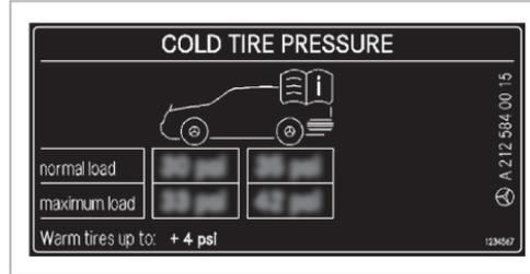
La tabla de presión de neumáticos muestra la presión del neumático recomendada para todos los neumáticos autorizados de fábrica para este vehículo. Las presiones recomendadas de neumáticos se aplican a los neumáticos fríos en distintos estados de servicio en cuanto a carga y/o velocidad del vehículo.
