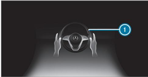
Si el sistema detecta que el conductor no gira el volante o que retira las manos del volante durante cierto tiempo, se emite la indicación ❶. Si el conductor sigue sin mover el volante de forma
