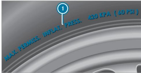
**i** Los datos de la ilustración son ejemplos. Nunca se debe sobrepasar la presión máxima admisible del neumático **1** para la que el neumático está homologado. Al ajustar la presión del neumático, tenga siempre en cuenta la presión recomendada para el vehículo. (→ página 341)
