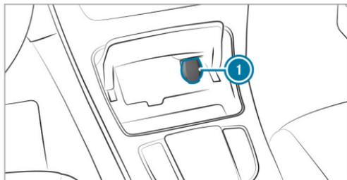
Caja de enchufe de 12 V situada en el compartimento portaobjetos situado en la consola central de la parte delantera (ejemplo)
