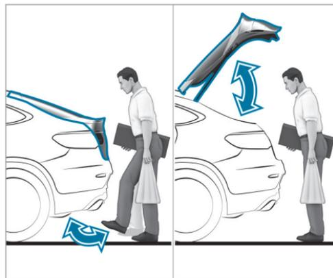
Con HANDS-FREE ACCESS puede abrir, cerrar o detener el portón trasero con un movimiento de la pierna en la zona situada debajo del parachoques. El movimiento de la pierna activa alternadamente la operación de apertura o de cierre.
