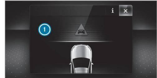
Si se ha realizado un frenado autónomo o se ha activado la servoasistencia de frenado en función de la situación, en el visualizador del cuadro de instrumentos se muestra la indicación ① que desaparece automáticamente poco después.
