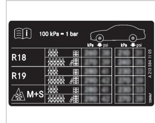
Algunas tablas de presión de neumáticos muestran solo diámetros de llanta en lugar de las dimensiones del neumático completo, por ejemplo, **R18**. El diámetro de la llanta forma parte del tamaño del neumático y está inscrito en el flanco del neumático (→ página 355).
