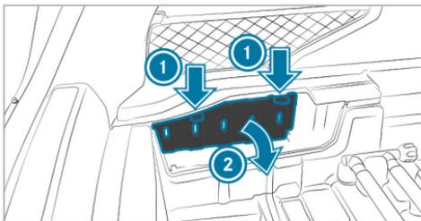
Para soltar las grapas de fijación ❶ de la cubierta, presione hacia abajo y levante la cubierta en la dirección de la flecha ❷.
