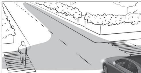
La luz de giro mejora la iluminación de la calzada en la dirección de giro, de manera que, por ejemplo, las curvas cerradas sean más visibles. Solo se puede activar la luz de giro si la luz de cruce está conectada.
