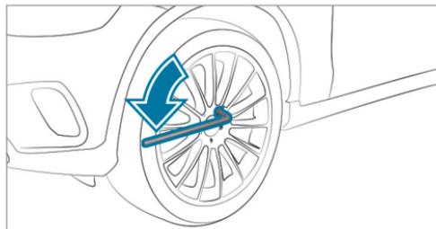
▶ Desenrosque aproximadamente una vuelta los tornillos de la rueda que va a cambiar con la llave de rueda, pero no los desenrosque por completo.
