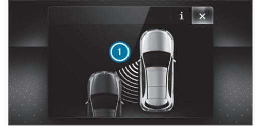
Si se produce una intervención en el freno para corregir la dirección, parpadea el testigo luminoso de advertencia rojo del retrovisor exterior y suena una señal acústica de advertencia. Adicionalmente se muestra una indicación ① en el visualizador del cuadro de instrumentos que indica el peligro de colisión lateral.
