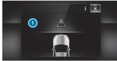
Si se ha realizado un frenado autónomo o se ha activado la servoasistencia de frenado en función de la situación, en el visualizador del cuadro de instrumentos se muestra la indicación ① que desaparece automáticamente poco después.
