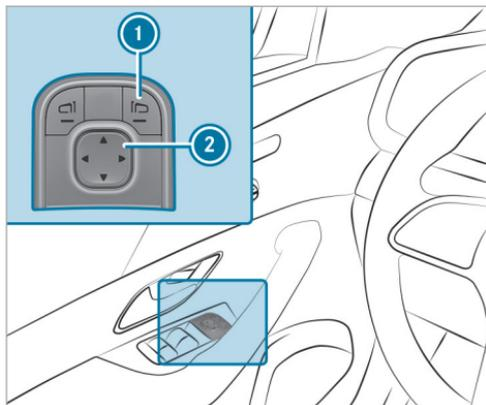
▶ Seleccione el retrovisor exterior del acompañante mediante la tecla **1**.
