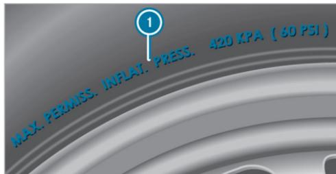
**i** Los datos de la ilustración son ejemplos. Nunca se debe sobrepasar la presión máxima admisible del neumático **1** para la que el neumático está homologado. Al ajustar la presión del neumático, tenga siempre en cuenta la presión recomendada para el vehículo. (→ página 408)
