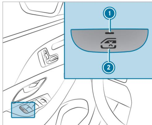
▶ **Activación/desactivación del seguro:** pulse la tecla ②.
