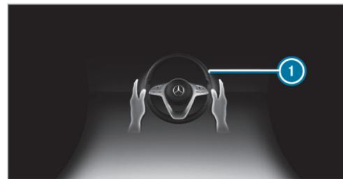
Si el sistema detecta que el conductor no gira el volante o que retira las manos del volante durante cierto tiempo, se emite la indicación 1. Si el conductor sigue sin mover el volante de forma activa, además de la advertencia óptica suena una señal acústica de advertencia.
