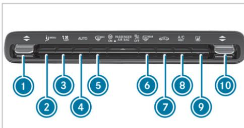
Unidad de mando de la climatización THERMOTRONIC con calefacción independiente (ejemplo)
