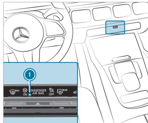
Si el sistema EDW está conectado, el testigo de control ⓘ parpadea.
