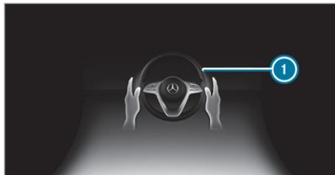
Si el sistema detecta que el conductor no gira el volante o que retira las manos del volante durante cierto tiempo, se muestra la indicación ❶ en el visualizador del cuadro de instrumentos. Si el conductor sigue sin realizar maniobras de forma activa o no responde al sistema, adicionalmente a
