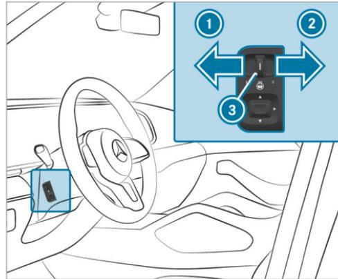
► **Conexión:** pulse el interruptor y ajústelo a la posición ①.
