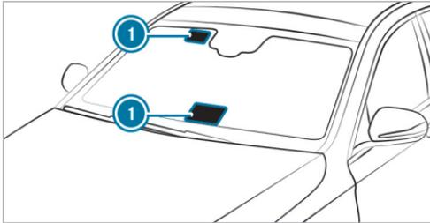
Los aparatos accionados por radio, como, por ejemplo, los sistemas de peaje, solo pueden montarse en las superficies permeables a las ondas radioeléctricas ❶ del parabrisas.
