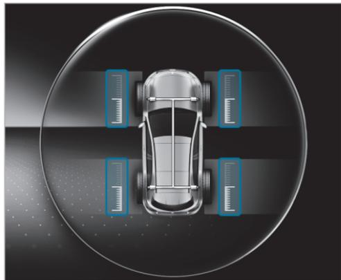
Puede visualizar la distribución actual de los pares de propulsión en las cuatro ruedas en el Head-up-Display y en el sector de visualización derecho del cuadro de instrumentos. Cuanto más se llene la respectiva escala, mayor será el par de propulsión correspondiente.
