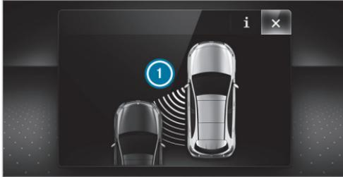
Si se produce una intervención en el freno para corregir la dirección, parpadea el testigo luminoso de advertencia rojo del retrovisor exterior y suena una señal acústica de advertencia. Adicionalmente se muestra una indicación ⓘ en el visualizador del cuadro de instrumentos que indica el peligro de colisión lateral.
