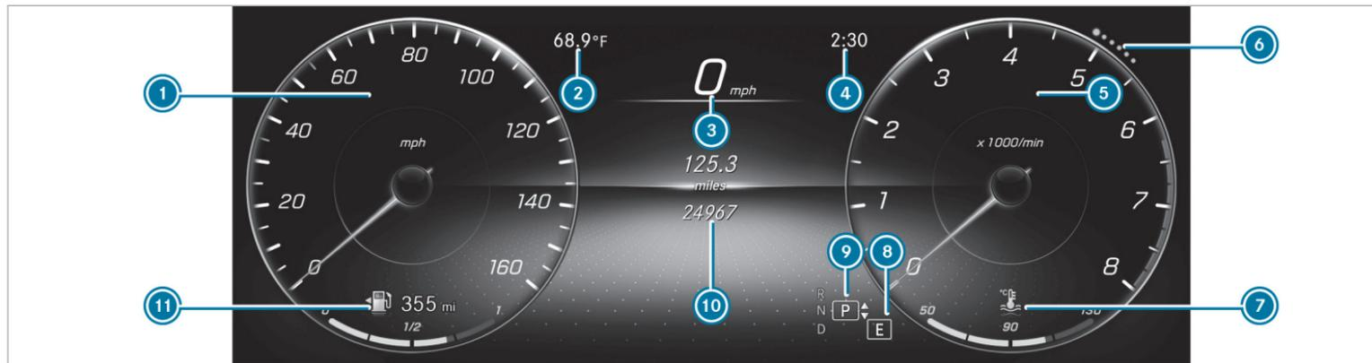
1 Sector de visualización izquierdo del cuadro de instrumentos (ejemplo, velocímetro): velocímetro/hora/fecha/ordenador de viaje Desde inicio y Desde reset/autonomía/audio/ángulo de ataque y de salida
