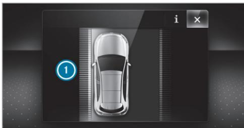
Si se produce una intervención en el freno para corregir el carril, en el visualizador del cuadro de instrumentos se muestra la indicación
