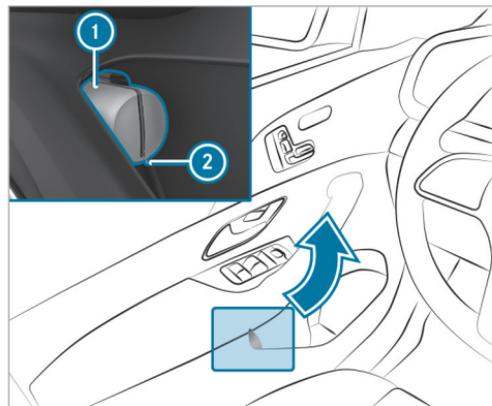
▶ **Extracción:** extraiga la bolsa del chaleco reflectante ① tirando del lazo ②.
