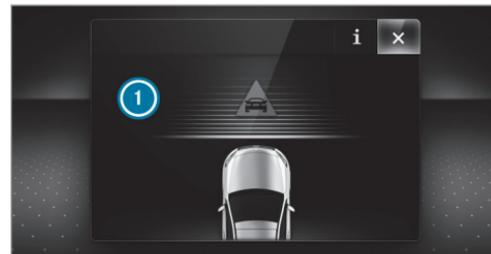
Si se ha realizado un frenado autónomo o se ha activado la servoasistencia de frenado en función de la situación, en el visualizador multifunción se muestra la indicación
