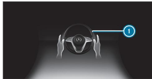
Si el sistema detecta que el conductor no gira el volante o que retira las manos del volante durante cierto tiempo, se emite la indicación ①. Si el conductor sigue sin mover el volante de
