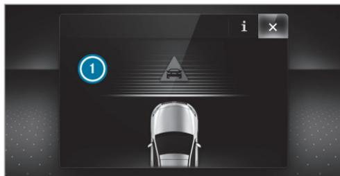
Si se ha realizado un frenado autónomo o se ha activado la servoasistencia de frenado en función de la situación, en el visualizador multifunción se muestra la indicación ❶ que desaparece automáticamente poco después.
