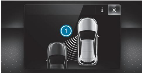
Si se produce una intervención en el freno para corregir la dirección, parpadea el testigo luminoso de advertencia rojo del retrovisor exterior y suena una señal acústica de advertencia. Adicionalmente se muestra una indicación **i** en el visualizador multifunción que indica el peligro de colisión lateral.
