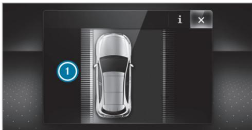
Si se produce una intervención en el freno para corregir el carril, en el visualizador multifunción se muestra la indicación ①.
