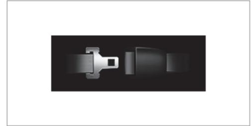
Con el encendido conectado, la indicación de estado de los cinturones de seguridad traseros muestra durante un tiempo determinado qué cinturón de seguridad trasero no está abrochado.
