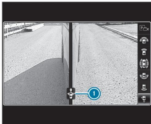
Si establece la conexión eléctrica del vehículo con el remolque, la indicación cambia a una vista de la cámara lateral ①.
