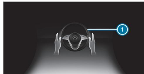
Si el sistema detecta que el conductor no gira el volante o que retira las manos del volante durante cierto tiempo, se emite la indicación ① en el visualizador multifunción. Si el conductor sigue sin realizar maniobras de forma activa o no responde al sistema, adicionalmente a la advertencia óptica se emite repetidamente una señal acústica de advertencia.
